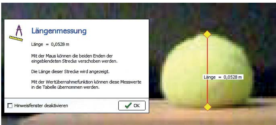
Abb. 5: Messung der Höhe des auftreffenden Tennisballes
