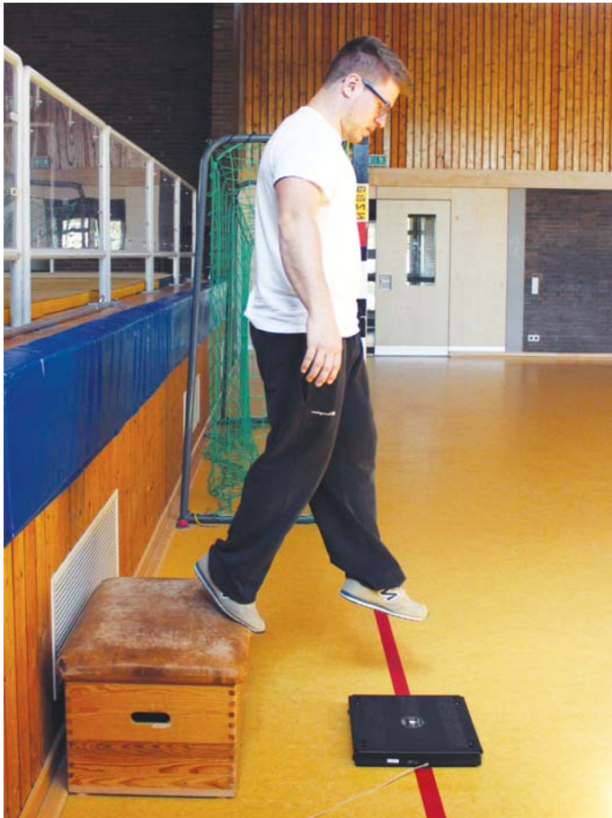
Abb. 1: Fall aus 0,40 m Höhe auf eine Kraftmessplatte
