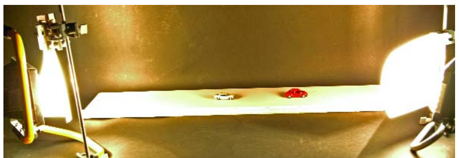
Abb. 12: Beleuchtung eines Stoßversuches mit zwei selbstgebaute Scheinwerfern mit diffusem Licht
