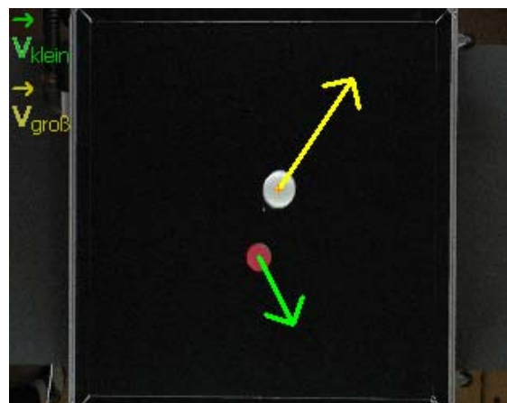
Abb. 7b: Geschwindigkeiten zweier Pucks nach dem Zusammenprall (Masseverhältnis von 1:1,77)
