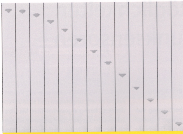
Abb. 23: Serienbild mit sehr schmalen Streifen (Streifenbild) ergibt ein t-y-Diagramm
