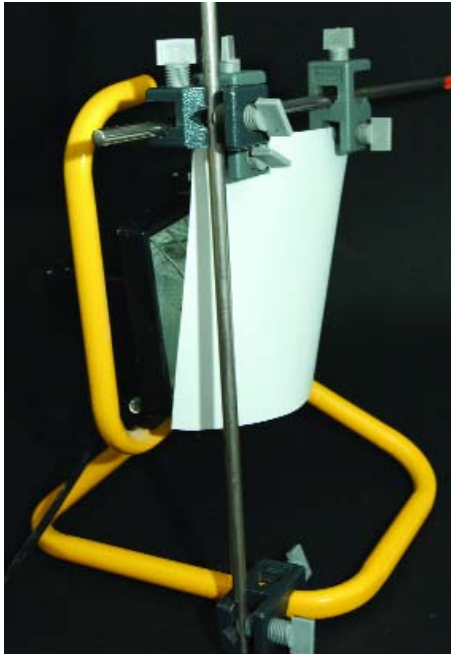
Abb. 13: Baustrahler mit vorgehängter Diffusorfolie
