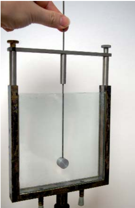
Abb. 13: Einfacher Versuchsaufbau zum Sichtbarmachen von Stromlinien
