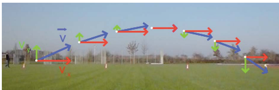
Abb. 9: Zerlegung der Geschwindigkeit in ihre Komponenten für einen Schuss vom Boden weg
