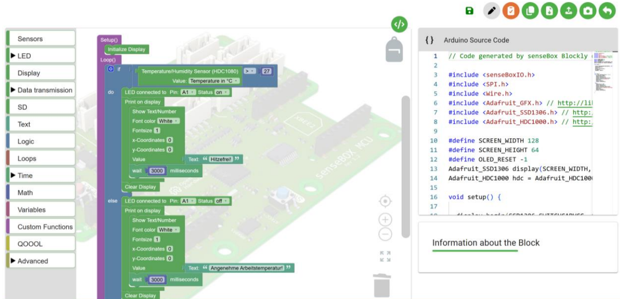
Abbildung 26: Screenshot der graphische Programmieroberfläche namens senseBox Blockly. Quelle: senseBox Blockly (2026).
