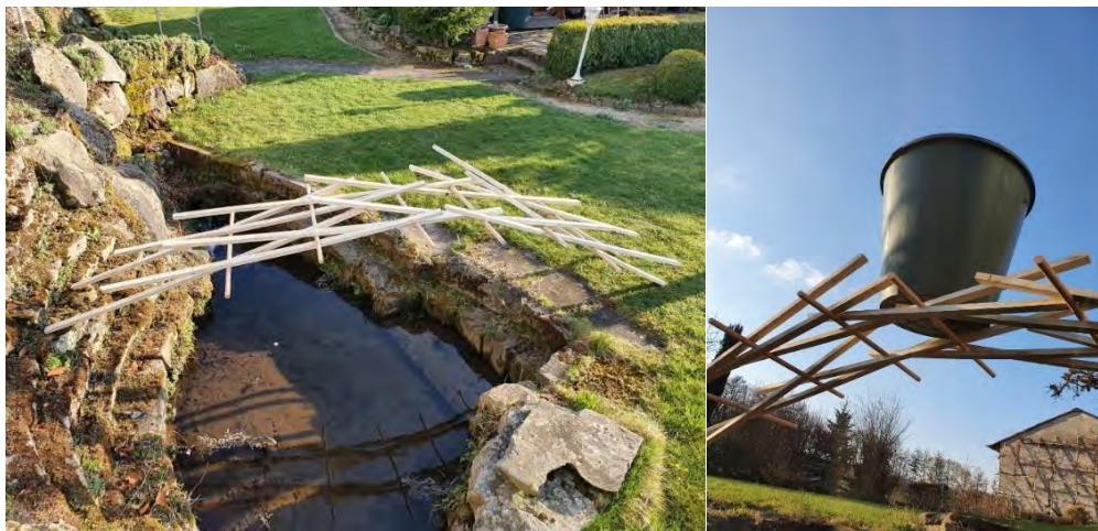
Abbildung 41: Links: Leonardo-Brücke, rechts: Leonardo-Brücke, die eine Wassertonne hält
