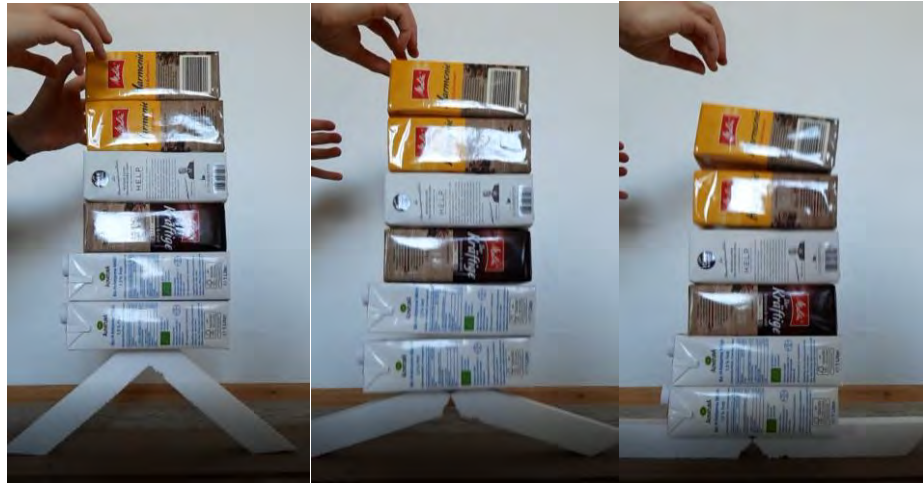
Abbildung 39: Belastung des Grundmodells anhand von Milchkartons und Kaffeepackungen (Bruch nach etwa 4 kg Belastung)
