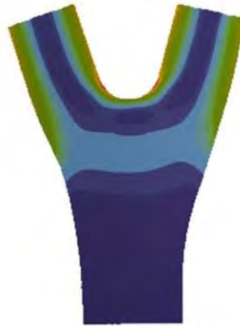
Abbildung 13: Spannungsverteilung in einer Baumgabel
