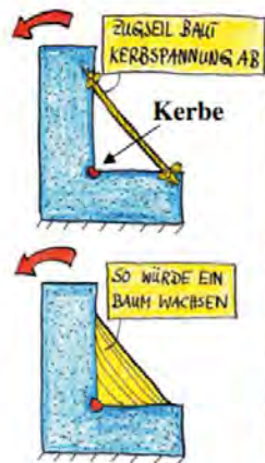
Abbildung 7: Kerbe, die der Baumstamm mit einem Wurzelanlauf überbrückt, der wie ein Zugdreieck wirkt
