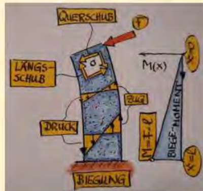
Abbildung 3: Kräfte, Spannungen und Biegemoment
