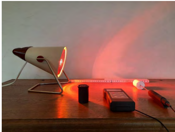
Abbildung 30: Versuchsaufbau (Teilversuch 1) zur Bestrahlung der Modelle mit einer Wärmelampe
