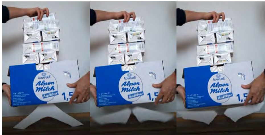
Abbildung 40: Belastung des Modells mit Zugdreiecken anhand von Milchkartons (Bruch nach etwa 21 kg Belastung)
