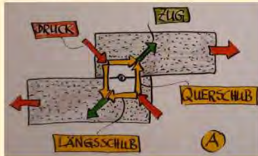
Abbildung 4: Zug-, Druck- und Schubspannungen
