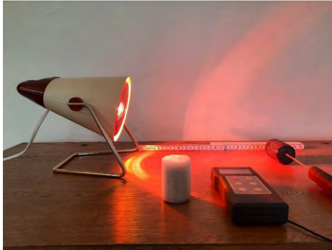
Abbildung 32: Versuchsaufbau (Teilversuch 2) zur Bestrahlung der Modelle mit einer Wärmelampe
