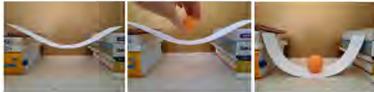
Abbildung 5: Belastung einer Papierbrücke mit einem Tischtennisball
