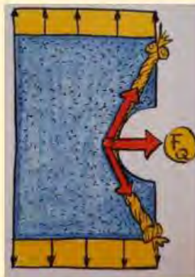
Abbildung 5: Kerbspannung an kreisförmig ausgerundeter Ecke
