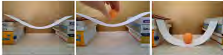
Abbildung 5: Belastung einer Papierbrücke mit einem Tischtennisball
