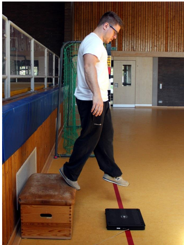
Abb. 1: Fall aus 0,40 m Höhe auf eine Kraftmessplatte
