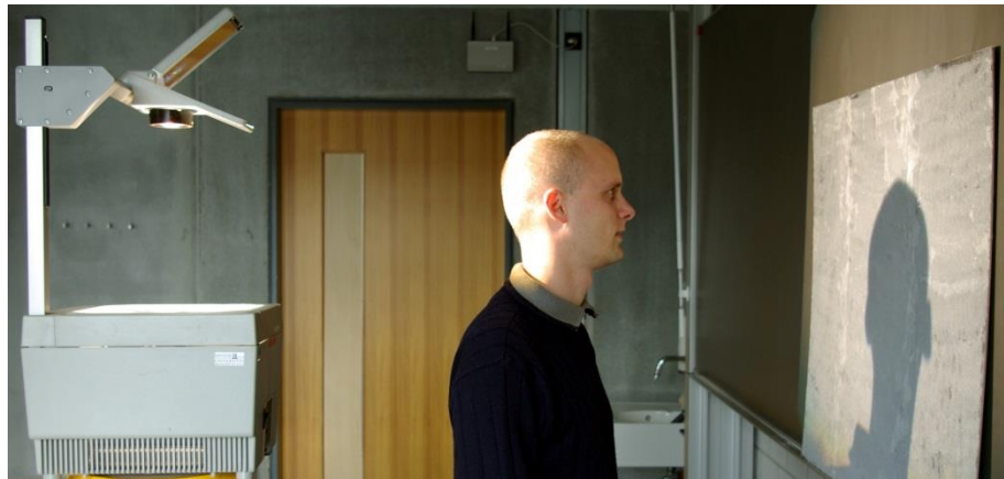
Abb. 4: Anordnung, um an der Tafel einen Vollkreis eines Regenbogens zu sehen (Abstand von der Tafel 0,6 m)
