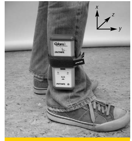
Abb. 20: Beschleunigungsmessung am Unterschenkel
