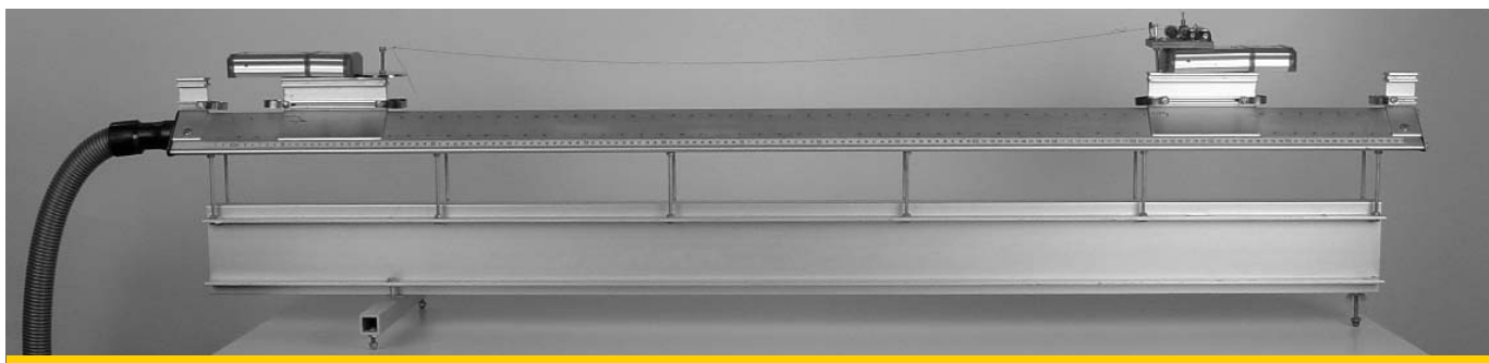
Abb. 4: „Skateboard-Versuch“ auf einer Luftkissenfahrbahn
