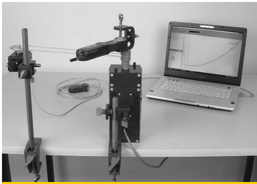
Abb. 12: Versuchsaufbau zur Bestimmung der Abhängigkeit der Radialbeschleunigung von der Geschwindigkeit mit Passport-Sensoren
