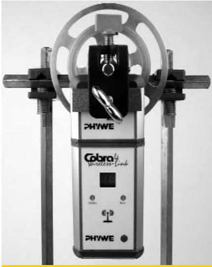
Abb. 16: Beschleunigungssensor als Stabpendel
