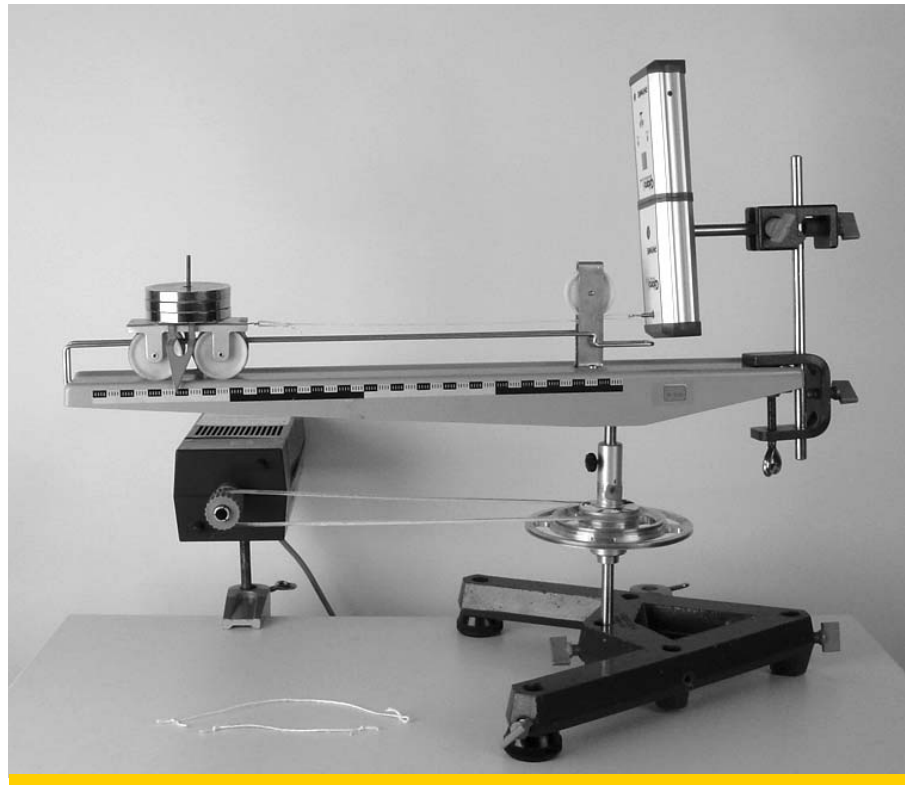
Abb. 23: Versuchsaufbau zur Zentripetalkraft mit dem Cobra4 -Kraftsensor
