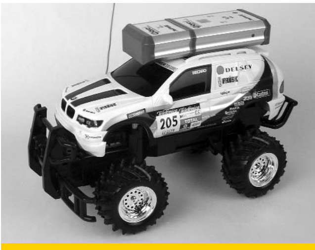
Abb. 14: Modellauto mit Beschleunigungssensor
