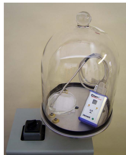
Abbildung 106: Versuchsaufbau zur Temperaturmessung im Rezipienten mit dem Cobra4 Temperatursensor
