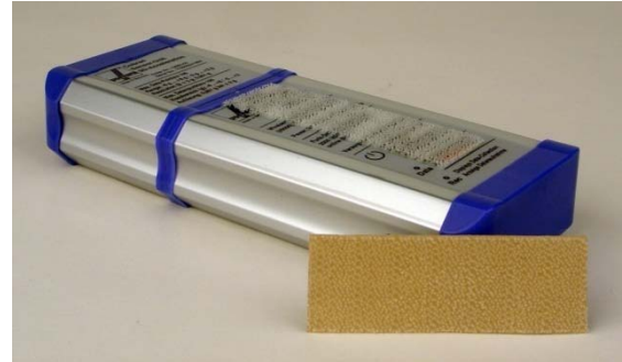
Abbildung 40: Cobra4-Beschleunigungssensor mit Rastsystem 3M Dual Lock
