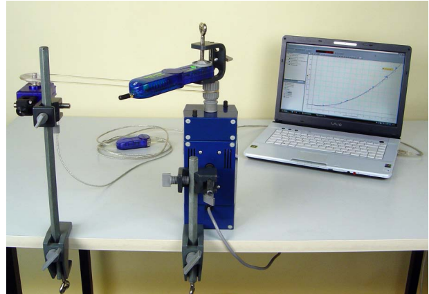
Abbildung 66: Untersuchung der Zentripetalbeschleunigung mit Pasport Beschleunigungs- und Drehwinkelsensor
