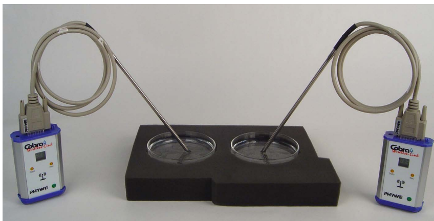
Abbildung 111: Aufbau des zweiten Experiments zum Mpemba-Effekt mit thermischer Isolierung
