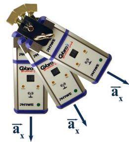
Abbildung 64: Richtung der Radialbeschleunigung am Cobra4 -Sensor bei einer Kreisbewegung
