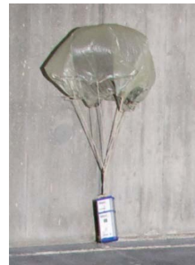
Abbildung 54: Cobra4-Beschleunigungssensor am selbst gebauten Fallschirm
