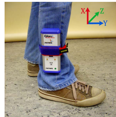
Abbildung 94: Cobra4 -Sensor am Unterschenkel befestigt
