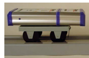
Abbildung 44: Experimentierwagen mit Cobra4-Beschleunigungssensor
