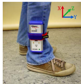
Abb. 20: Beschleunigungsmessung am Unterschenkel
