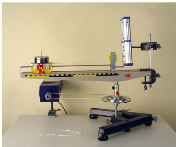
Abb. 23: Versuchsaufbau zur Zentripetalkraft mit dem Cobra4-Kraftsensor
