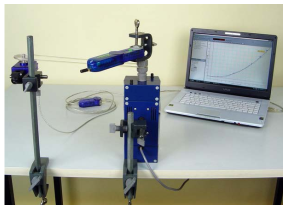
Abb. 12: Versuchsaufbau zur Bestimmung der Abhängigkeit der Radialbeschleunigung von der Geschwindigkeit mit Passport-Sensoren
