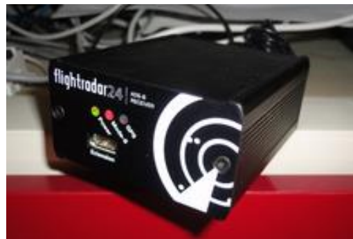
Abbildung 4 Ein von Flightradar24 bereitgestellter ADS-B-Empfänger von flightradar24.com
