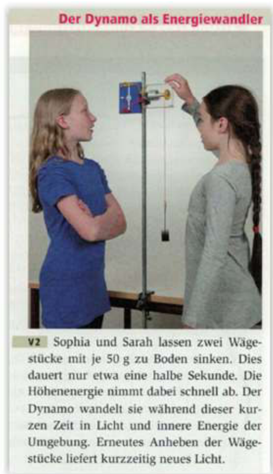
Abbildung 21: Dynamo als Energiewandler (DORN BADER Bd. 1, S. 125).
