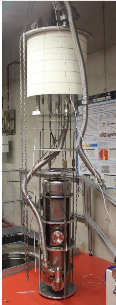
Abbildung 19: Supraleitender Beschleuniger (unteres silbernes Gehäuse) mit Helium-Kühlung (weißer Zylinder oben)
