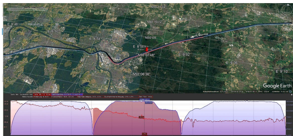
Abbildung 54 Zugfahrt von Gelnhausen nach Offenbach mit Höhen bzw. Geschwindigkeitsprofil und markiertem Bereich (Ansicht in Google Earth, aufgenommen mit Geo-Tracker)
