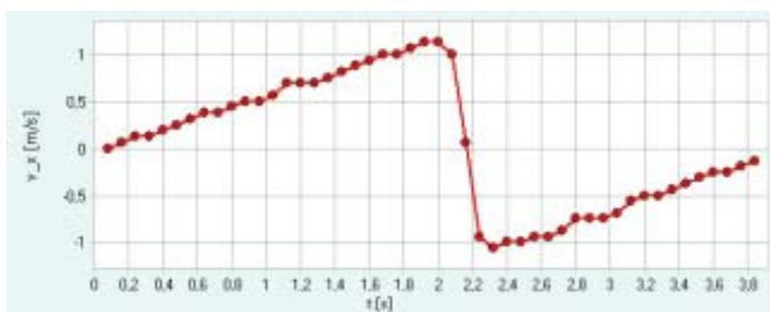
Abbildung 3.17:  $t$ - $v_x$ -Diagramm des Wagens auf der schiefen Ebene (gedrehtes Koordinatensystem)
