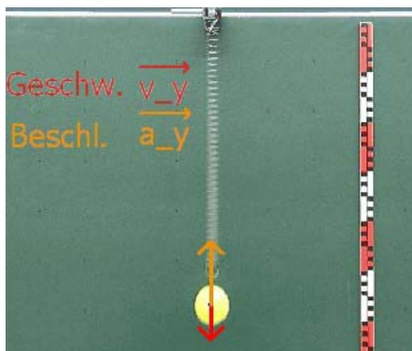
Abbildung 3.4: Federpendel mit „angehefteten“ Vektoren
