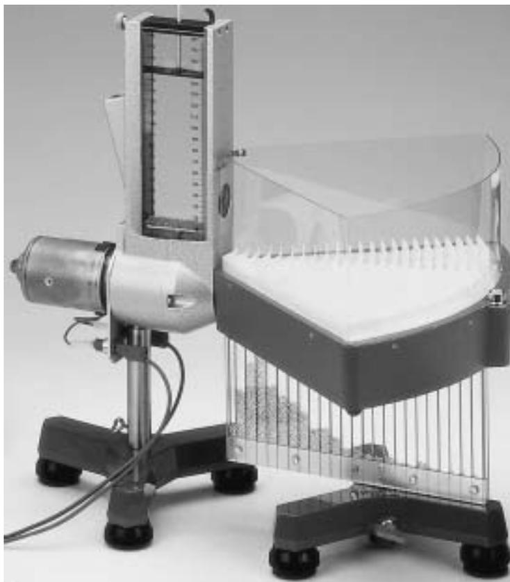
Abbildung 4.17: Phywe-Gerät zur kinetischen Gastheorie
