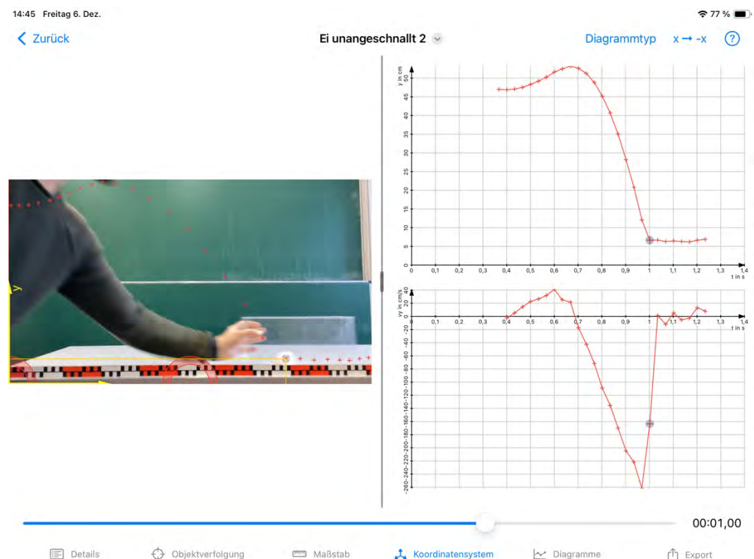
Abbildung 35: Vergleich von Videoausschnitt und Diagrammen mittels „grauen Punkten“ zur Bestimmung von „Momenten“, in denen das zweite Newton'sche Axiom wirkt
