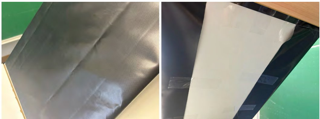
Abbildung 50: TPU-beschichtetes Nylogewebe als Notrutschenoberfläche (links) und dessen Befestigung auf der Rückseite des schiefen Brettes (rechts)
