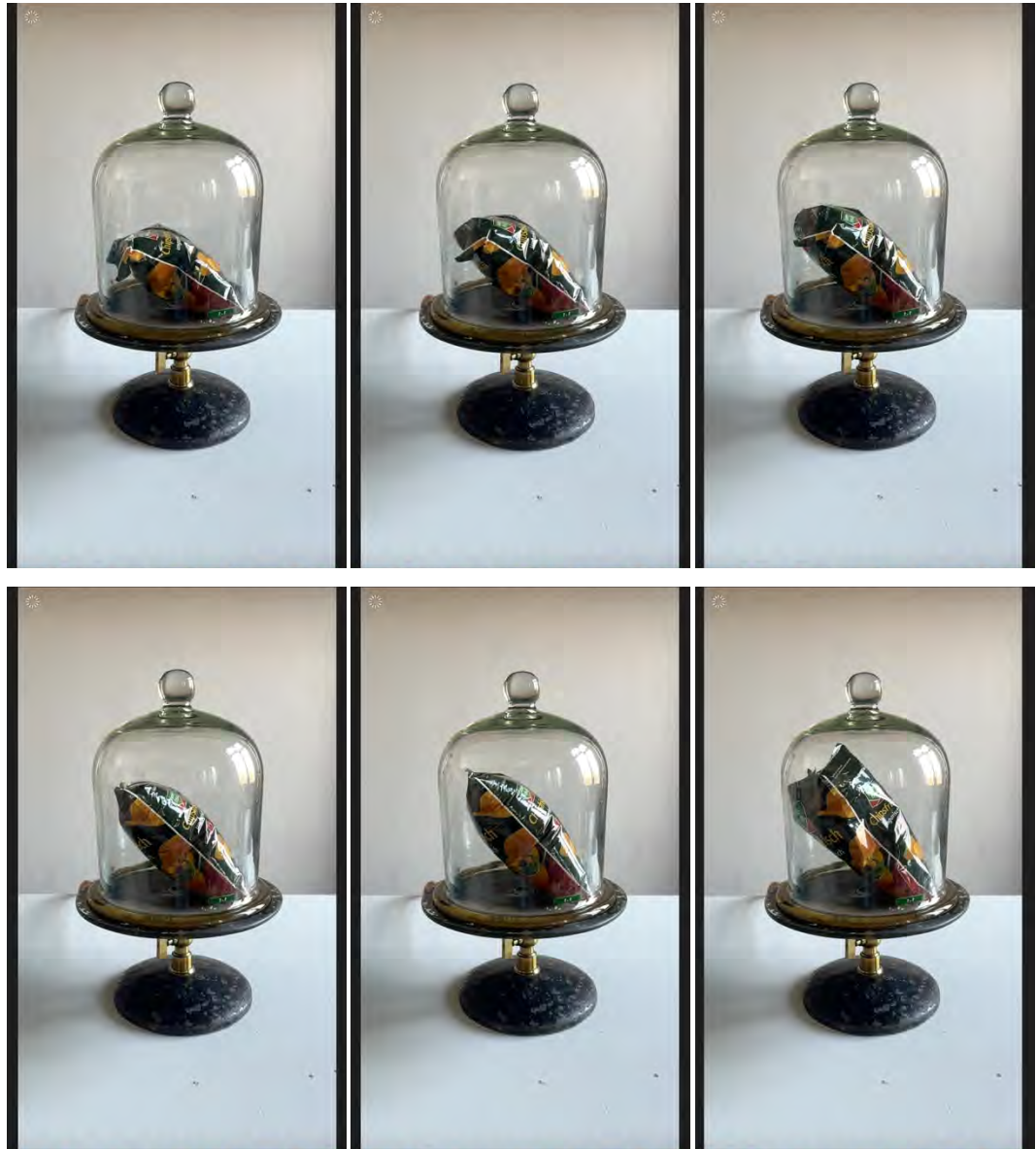
Abbildung 67: Ablauf des Experiments zum Modellieren einer Hochdruck-Flugzeugkabine und einer Niederdruck-Umgebung (Frontperspektive)
