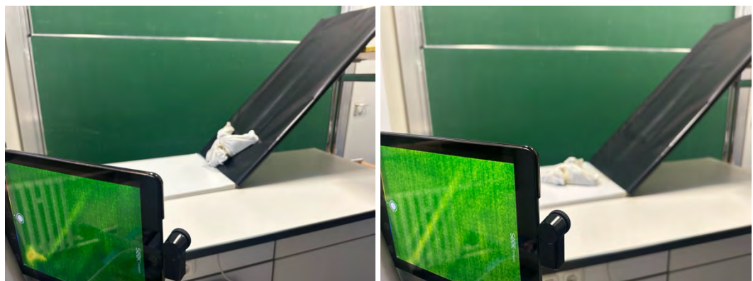
Abbildung 56: Wärmebilder der schiefen Ebene nach Hinabrutschen des mit Baumwolle bespannten Gewichts
