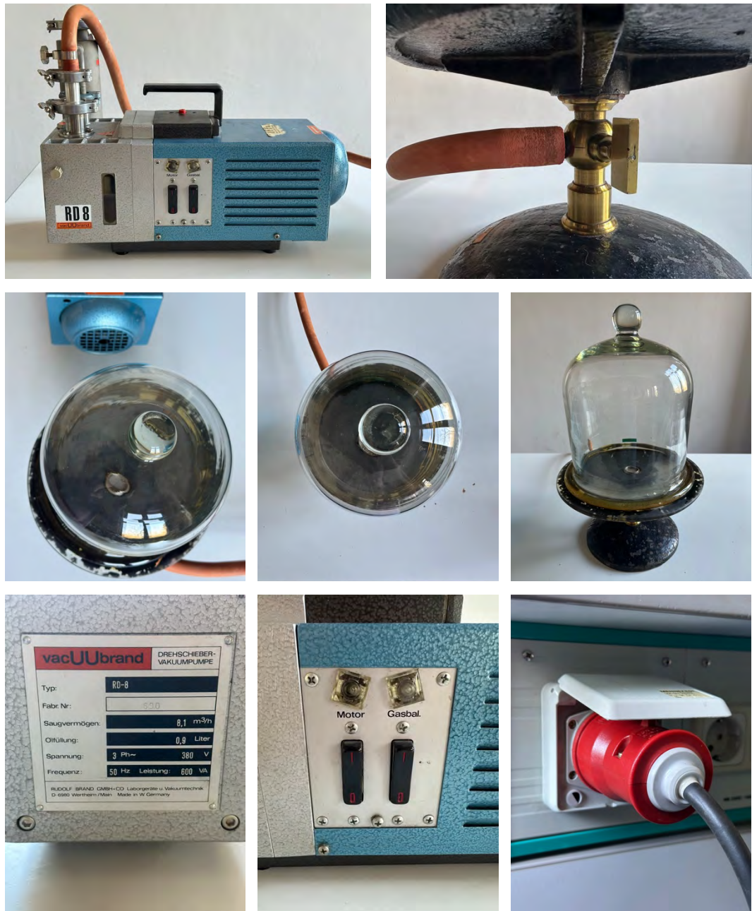
Abbildung 66: Aufbau des Experiments zum Modellieren einer Hochdruck-Flugzeugkabine und einer Niederdruck-Umgebung
