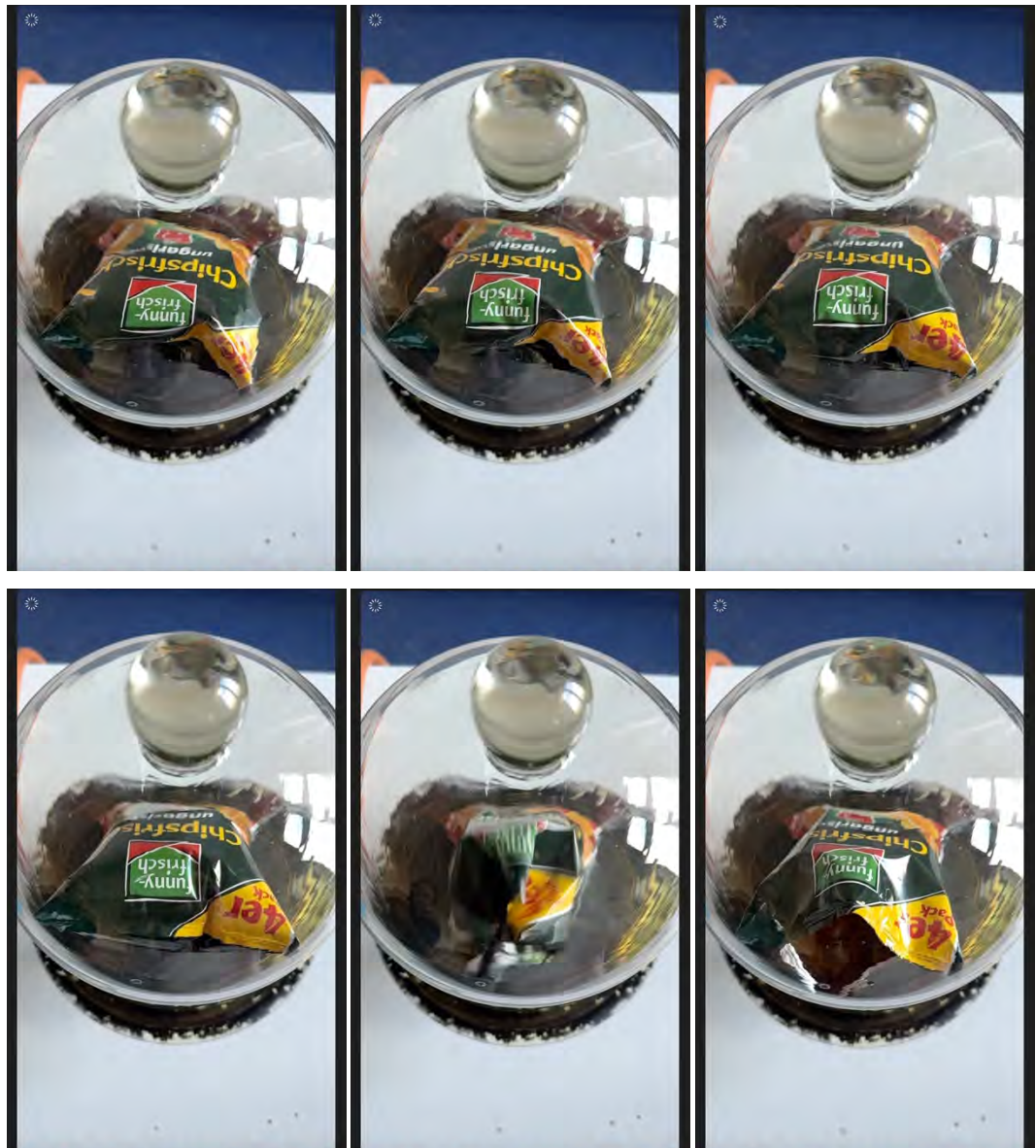
Abbildung 68: Ablauf des Experiments zum Modellieren einer Hochdruck-Flugzeugkabine und einer Niedrigdruck-Umgebung (Vogelperspektive)
