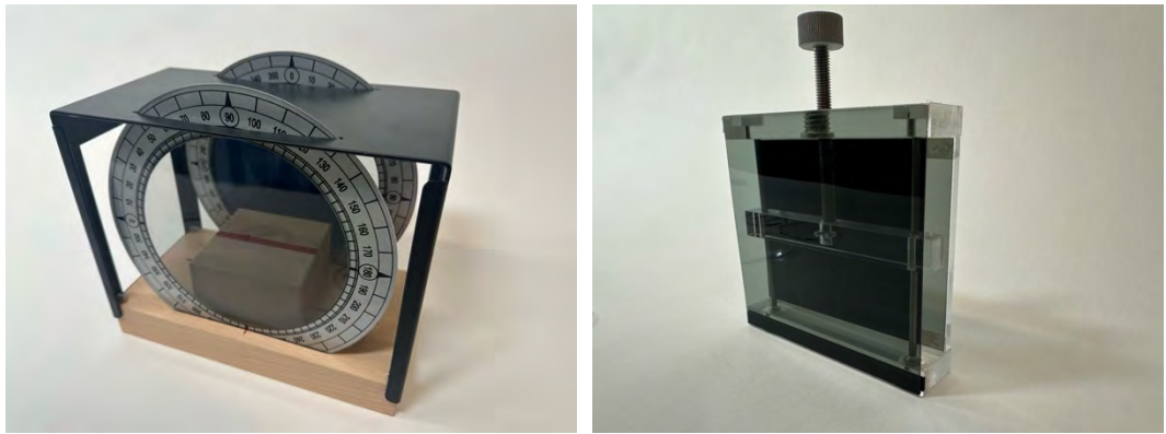
Abbildung 69: Aufbau der zwei Polarisationsfolien inkl. Bereich zum Einklemmen von Untersuchungsmaterialien dazwischen, Set zum Zusammenstecken (links), bereits fertige Klappe mit Schraubpresse (rechts)
