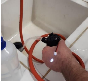
Abbildung 13: Generator bringt LED zum Leuchten. 81
