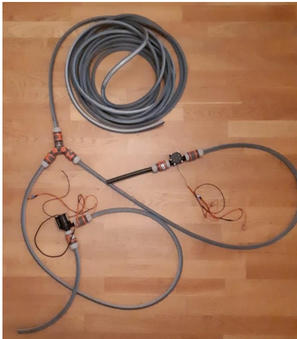
Abbildung 19: Schlauchnetz mit Pumpe und Generator
