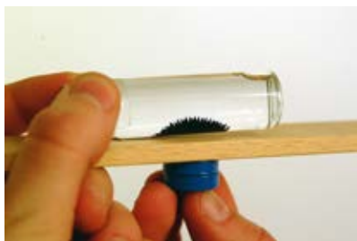
(c) Visualisierung mit Ferrofluid (geringe Permeabilität)
