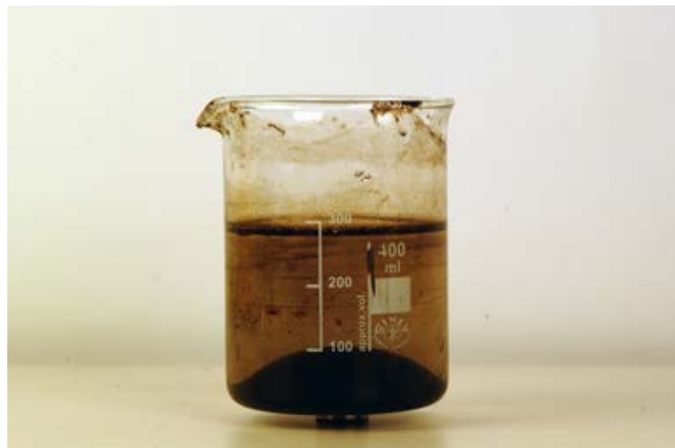
Abb. 10.4: Nach vollständiger Zugabe von Ammoniumhydroxid lässt man den Niederschlag absetzen. Die klare Flüssigkeit wird mehrmals abdekantiert.
