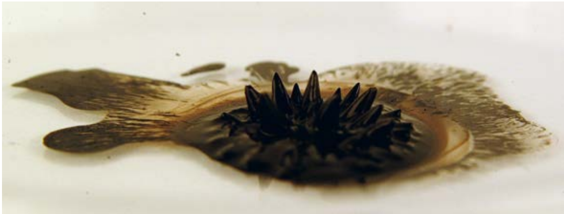
Abb. 10.5: Nach Zugabe der 25%-igen Tetramethylammonium-Hydroxid-Lösung erhält man das Ferrofluid.
