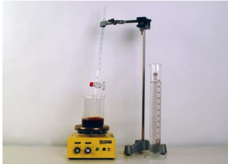
Abb. 10.3: Die tröpfchenweise Zugabe von verdünntem Ammoniumhydroxid führt zur Ausfällung von Magnetit.
