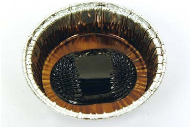
Abb. 12.5: Wenn die Magnetfeldlinien parallel zur Oberfläche der Flüssigkeit verlaufen, bilden sich keine Instabilitäten.
