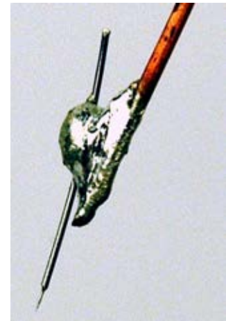
(c) Eine korrekt geätzte Spitze
