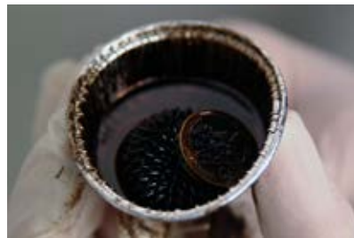
(c) Bei Anlegen eines externen Magnetfelds kommt die Münze wieder zum Vorschein.
