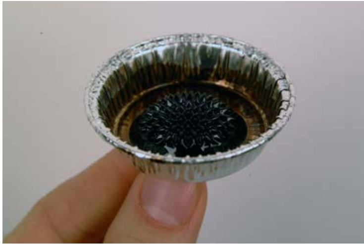
Abb. 12.4: Ausbildung von Rosensweig-Instabilitäten, wenn die magnetischen Feldlinien des Permanentmagnetens senkrecht auf die Oberfläche der Flüssigkeit treffen.
