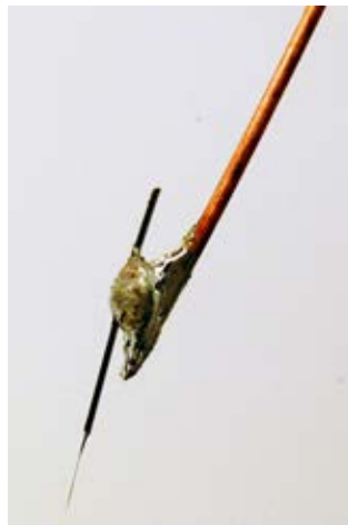
(b) Eine unvollständig geätzte Spitze
