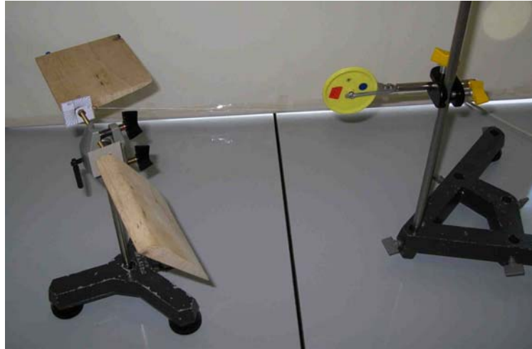
Abb. 4.8: Aufbau zur Messung der Widerstandskraft [eigenes Foto vom 04.07.07]
