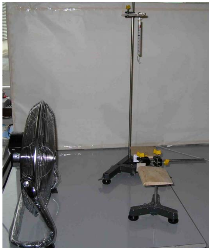
Abb. 4.7: Gesamtaufbau zur Messung der Auftriebskraft [eigenes Foto vom 04.07.07]
