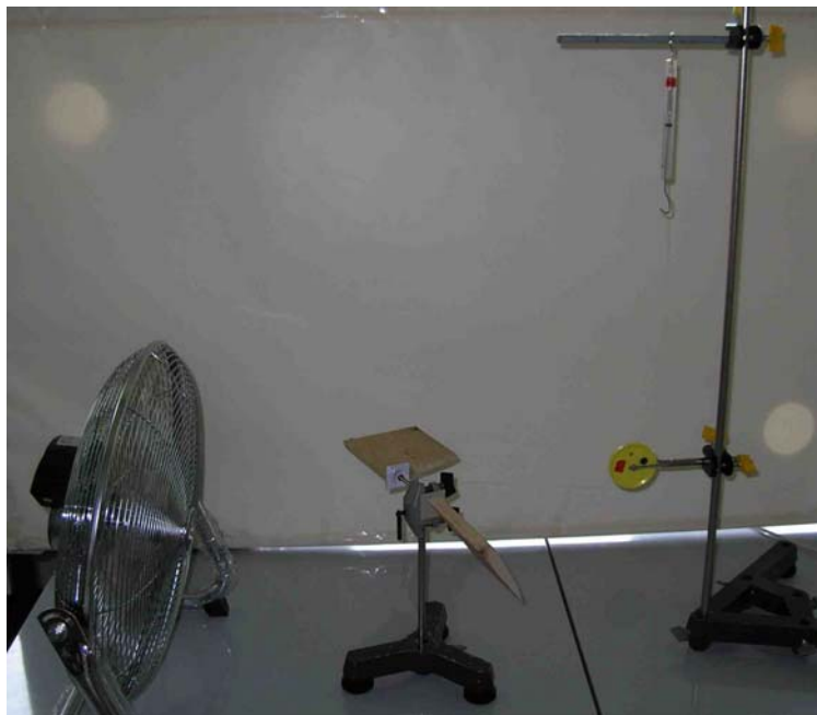
Abb. 4.9: Gesamtaufbau zur Messung der Widerstandskraft [eigenes Foto vom 04.07.07]
