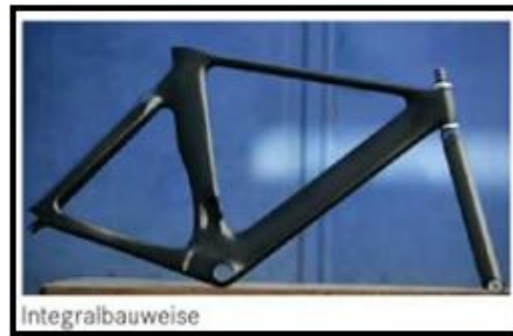
Abb. 18 Rennradrahmen in Integralbauweise 47
