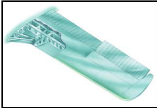
Abb. 22 Integraltank zwischen den Tragflächenrippen eines Flugzeugflügels 55
