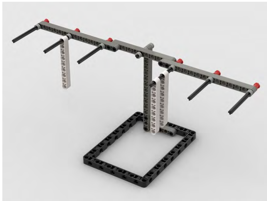
Abbildung 1: Hebelversuch mit Lego, eigenes Rendering erzeugt mit Studio 2.0
