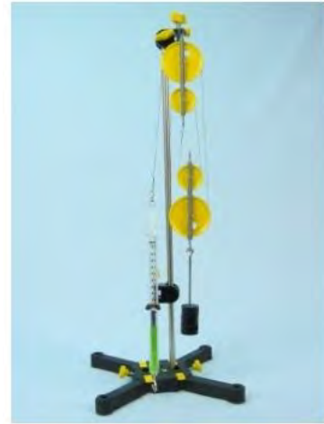
Abbildung 6: Flaschenzug mit Ständer, übernommen aus Flaschenzug mit 4 Rollen , von PHYWE Systeme GmbH & Co. KG, o. D., www.phywe.de/versuche-sets/schuelerversuche/flaschenzug-mit-4-rollen_9692_10623/
