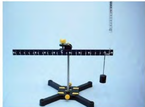
Abbildung 3: Einseitiger Hebel Phywe, übernommen aus Einseitiger Hebel , von PHYWE Systeme GmbH & Co. KG, o. D., www.phywe.de/versuche-sets/schuelerversuche/einseitiger-hebel_9695_10626/
