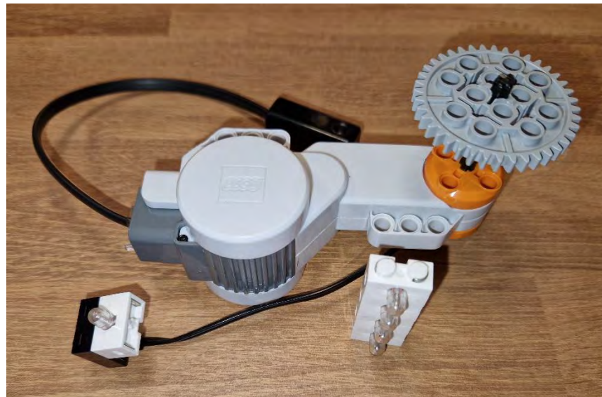
Abbildung 32: Dynamo Versuch mit Lego, eigenes Foto
