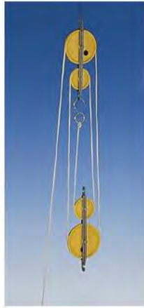
Abbildung 5: Flaschenzug mit 4 Rollen, übernommen aus Flaschenzug mit 4 Rollen , von PHYWE Systeme GmbH & Co. KG, o. D., www.phywe.de/physik/mechanik/dynamik-bewegung/flaschenzug-mit-4-rollen_449_1380/
