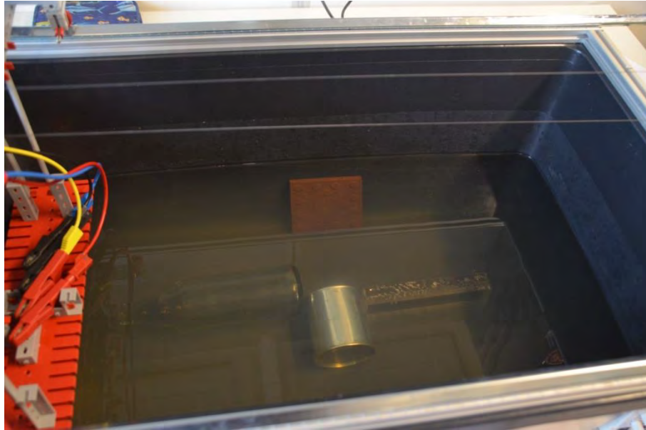
Abbildung 7.8: Station 3 im Schülerlaborversuch: Widerstandsmessung von Störkörpern: Glasflasche, Blechdose, Plexiglasblock
