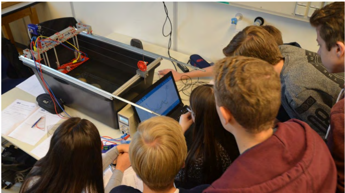
Abbildung 7.7: Station 3 im Schülerlaborversuch: Widerstandsmessung von Störkörpern und Darstellung der Messgraphen auf dem PC.
