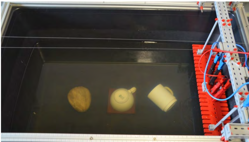
Abbildung 6.30: Messung mit den Störkörpern Stein, Tasse und Becher
