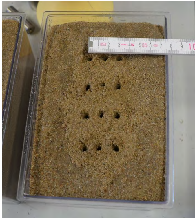
Abbildung 6.5: Messpositionen des Messrechen in der kleinen Wanne bei Sandfüllung
