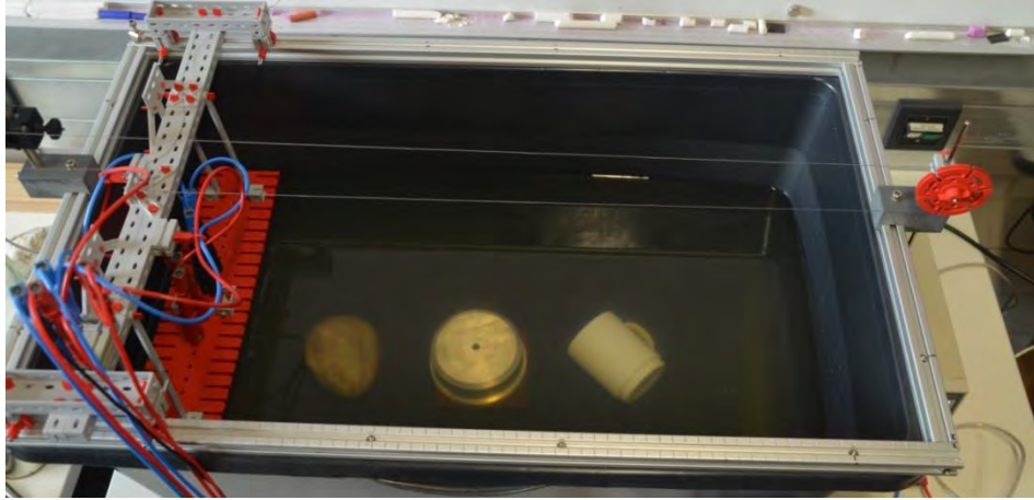
Abbildung 6.33: Messung mit den Störkörpern Stein, Aluminiumblock und Becher
