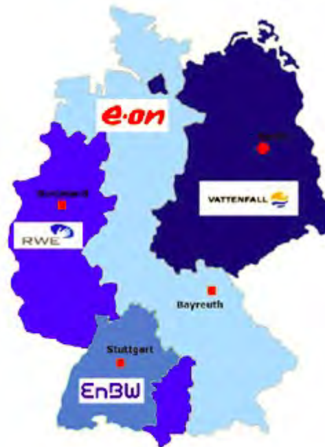
Abbildung 9: Regelzonen der vier größten Stromversorger Deutschlands, die jeweiligen Zonen werden von den zum Versorgungsunternehmen zugehörigen Netzbetreibern betrieben
