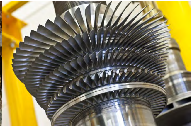
Abbildung 17: offenes Turbinengehäuse einer Dampfturbine mit messingfarbenen Leitschaufeln Abbildung 18: Dampfturbinen-Laufräder mit Laufschaufeln
