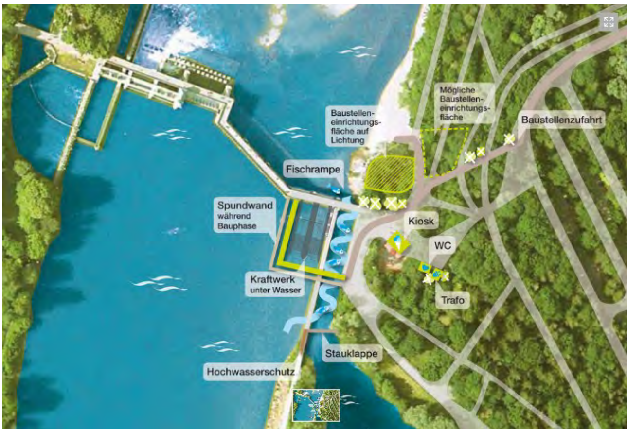
Abbildung 27: Überblick über den Hochablass und die Baustelle für das neue Wasserkraftwerk
