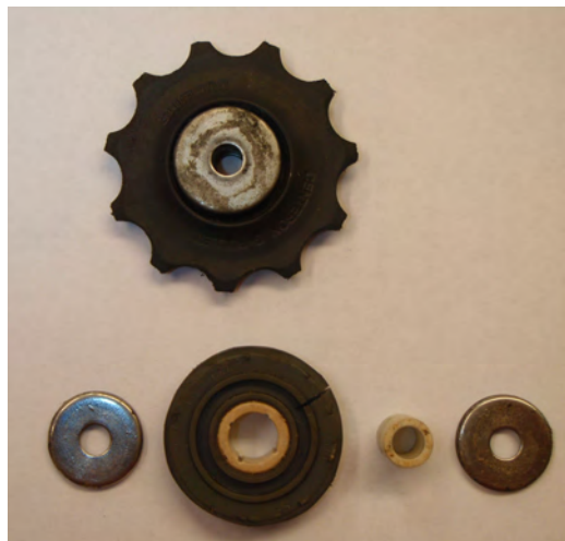
Abbildung 35: Schalungsrad einer Fahrradgangschaltung, oben ganz, unten mit abgeschliffenen Zähnen und auseinandergenommenem Lager
