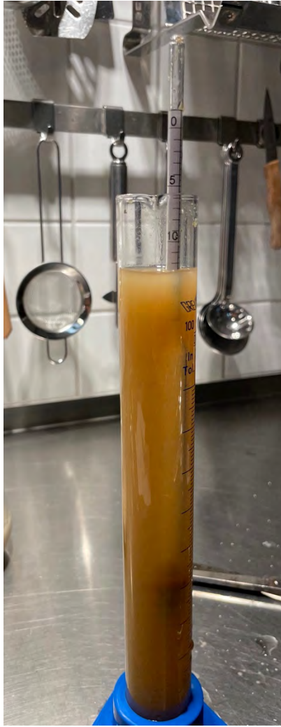
Abbildung 14 - Würze wird gespindelt
