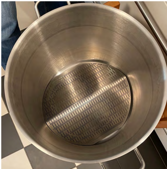
Abbildung 6 - Läuterbottich mit Läuterblech
