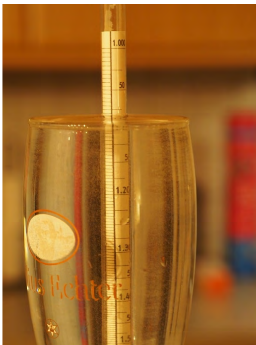
Abbildung 62 - Dichte von Zuckerwasser (500 ml Wasser + 100 g Zucker)
