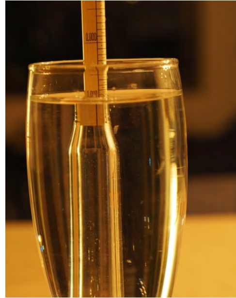
Abbildung 60 - Dichtebestimmung von Wasser in einem Weizenglas (500 ml) Abbildung 61 - Nahaufnahme des Aräometers in einem Weizenglas (500 ml)
