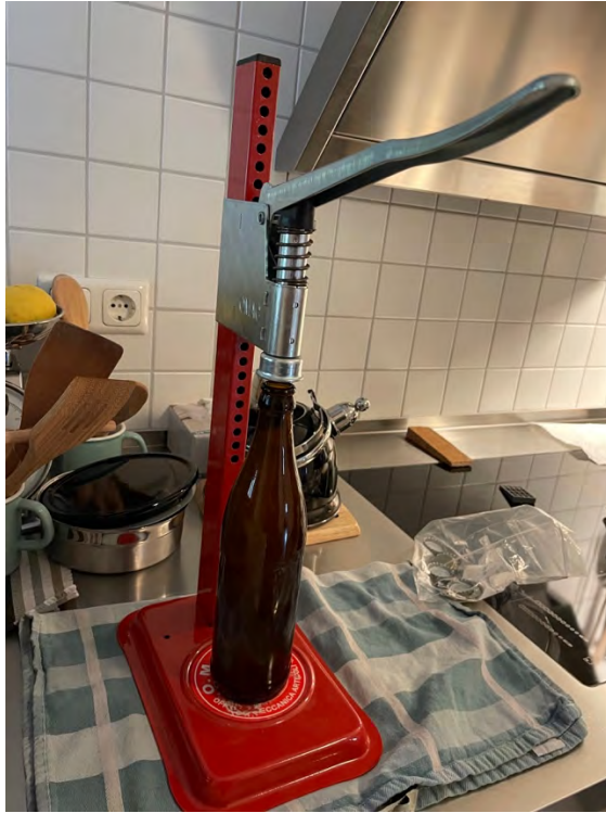
Abbildung 40 - Kronkorkenverschlussgerät (einseitiger Hebel)
