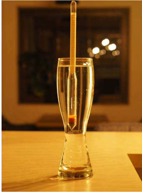
Abbildung 60 - Dichtebestimmung von Wasser in einem Weizenglas (500 ml) Abbildung 61 - Nahaufnahme des Aräometers in einem Weizenglas (500 ml)
