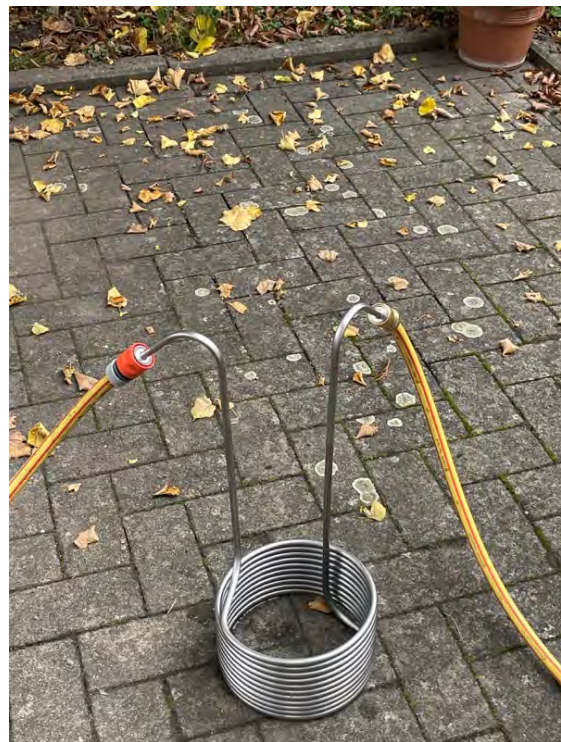
Abbildung 20 - Kühlspirale (links kaltes Wasser aus dem Hahn, rechts erwärmtes Wasser)
