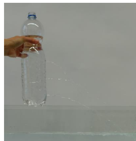
Abb. 19: Die drei Wasserstrahlen sind unterschiedlich stark ausgeprägt.
