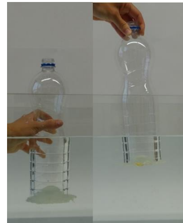
Abb. 10: Die Membran der linken Flasche wölbt sich stärker nach innen.
